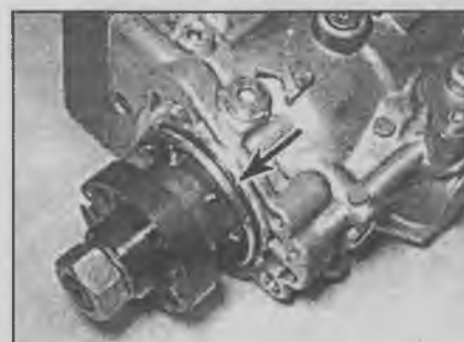
4.18. Расположение уплотнительного кольца на топливном насосе
