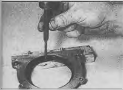
18.11 Выбейте задний сальник коленчатого вала из кожуха
