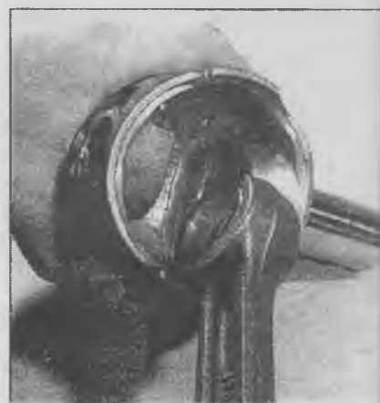
14.12б ...и снимите поршневой палец для того, чтобы снять поршень с шатуна
