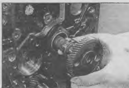
9.6 Снимите распределительный вал – двигатель объемом 2,5 литра
