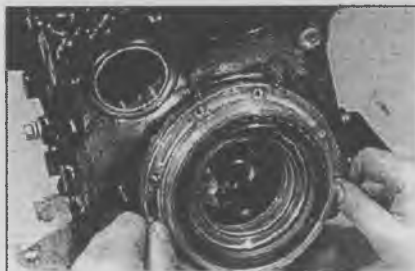
12.13а Снимите кронштейн заднего подшипника...
