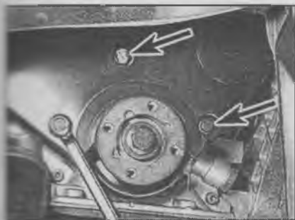
27.16 Болты нижней крышки зубчатого ремня распределителя (дизель 17DR, шкив коленвала снят)
