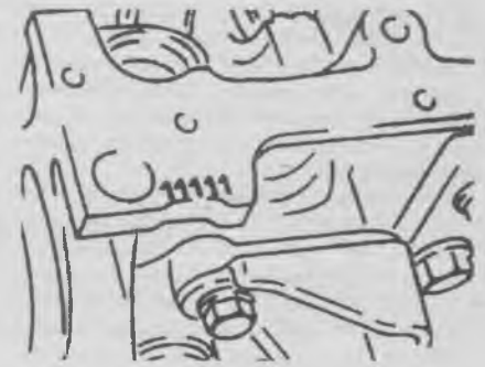
33.2 Маркировка вкладышей коренных подшипников протампована на блоке цилиндров
