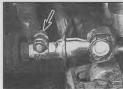
21.25 Отсоедините рычажный механизм коробки передач
