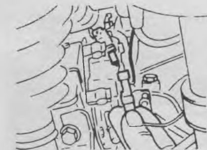
21.30 Отсоедините провод от электромагнитного клапана топливного насоса
