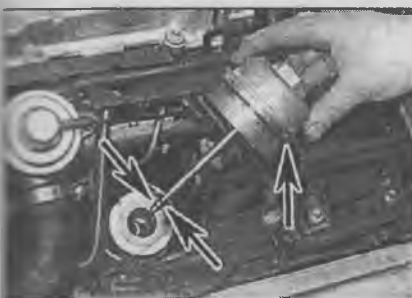
1.6. Расположение уплотнительных колец на крышке кожуха фильтрующего элемента
