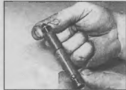
4.21. Установка нового уплотнительного кольца на топливную форсунку
