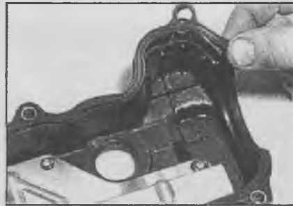
7.29 Установите прокладку в канавку крышки головки цилиндров
