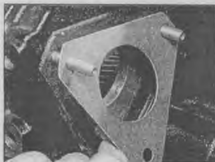
11.39б ... и снимите прокладку – автомобиля с двигателем объемом 2,5 л
