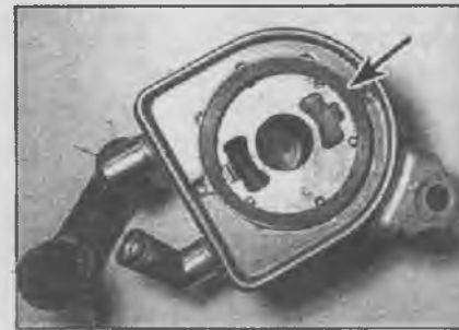
12.8 Замените уплотнительное кольцо масляного радиатора (указано стрелкой)
