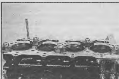
19.14 Зажмите все гильзы в блоке цилиндров после установки – двигатель объемом 2,5 литра
