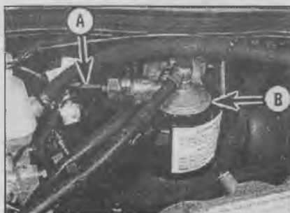
6.1 Температурный датчик (А) и нагревательный элемент (Б) топливного фильтра
