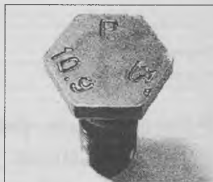
17.9 Проверьте чтобы болт с буквой Р был вставлен правильно.
