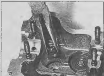
27.9а Снимите сальник штока клапана
