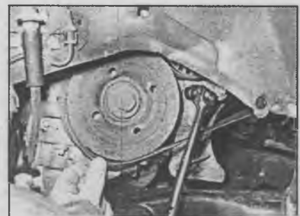
1.7. Освобождение механизма натяжения приводного ремня на двигателях 2,0 л
