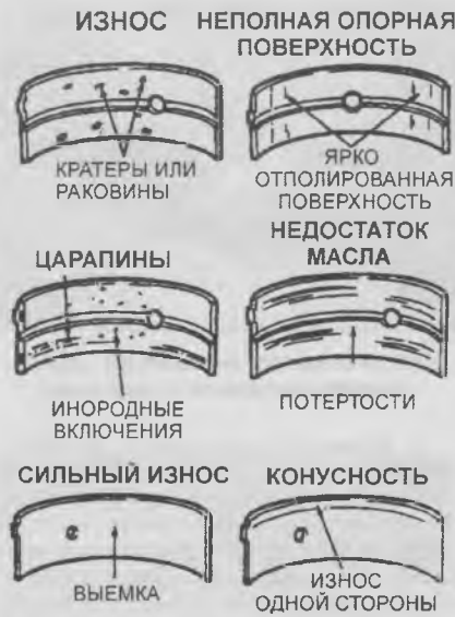
2.35. Типичные дефекты подшипников
