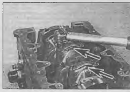
2.52. Затягивание болтов крепления крышки нижней головки шатуна динамометрическим ключом
