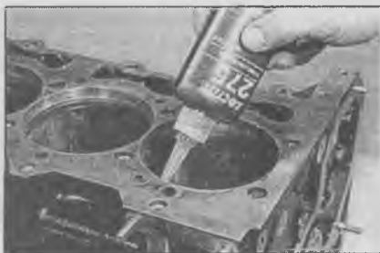
19.12а Нанесите клей Loctite 275 на кромку седла гильзы в блоке цилиндров...
