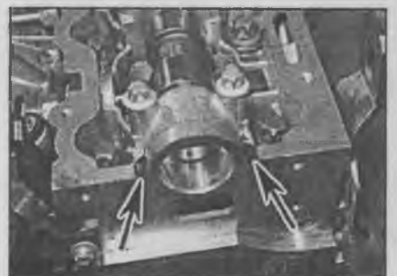
2.18. Места нанесения герметика на крышку головки блока цилиндров
