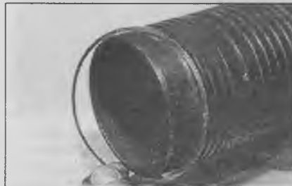
19.10а Установите шайбы на гильзу цилиндра...
