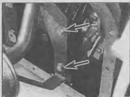
16.13а Вывинтите два болта опорного кронштейна и снимите маслоприемный патрубок и сетчатый фильтр,
