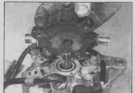
1.3 Снятие насоса с генератора
