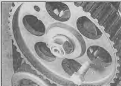
4.10б Вставьте блокировочный болт в отверстие звездочки топливного насоса
