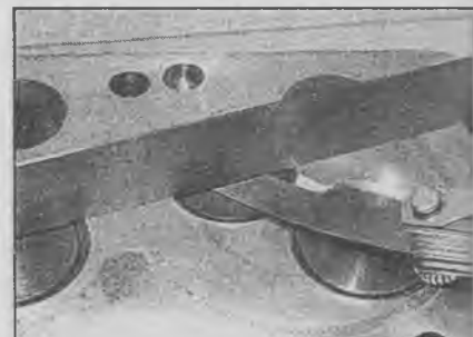
24.9 Измерьте высоту выступа головки клапана
