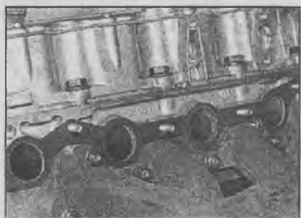
16.3 Прокладка впускного коллектора
