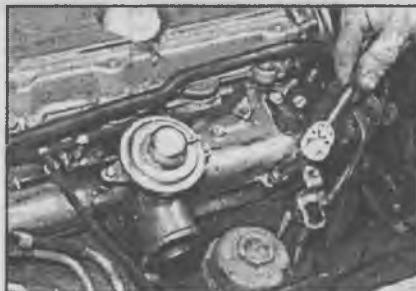
4.31. Отвинчивание болтов крепления верхней части коллектора
