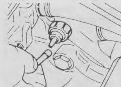
21.17б Отсоедините провод от выключателя сигнальной лампы давления масла
