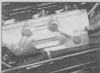
17.2а Снимите теплозащитный экран с выпускного коллектора...
