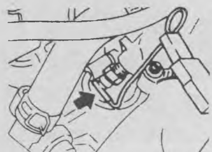
21.17а Отсоедините провод от датчика температуры охлаждающей жидкости (указан стрелкой)
