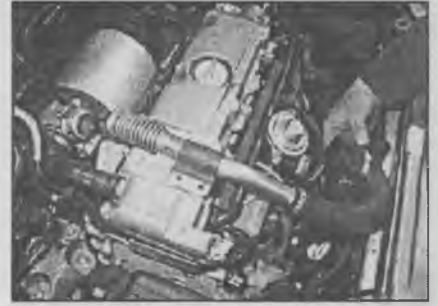
2.14. Снятие трубы, соединяющей турбоагрегат и коллектор
