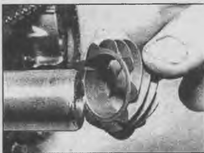
9.3 Снятие ведущего зубчатого кольца топливного насоса с коленчатого вала
