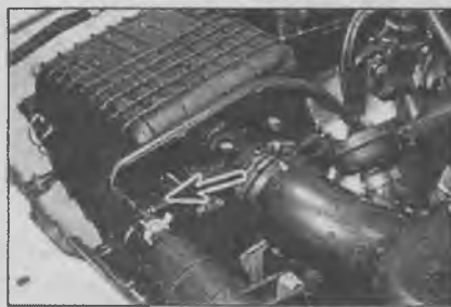
8.7 Разъем воздухомера (указан стрелкой) – модели с 2,5-литровым двигателем
