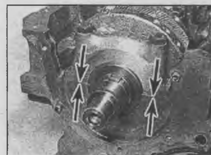
29.10 Стык передней крышки и блока цилиндров (указан стрелками) должен быть ровным
