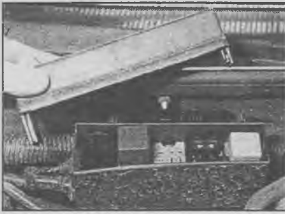
5.2г Предохранитель системы предварительного подогрева расположен в блоке предохранителей в двигательном отсеке
