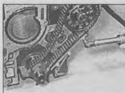
2.26. Снятие звездочки цепи с топливного насоса
