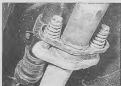
17.16а Гибкое соединение выпускной трубы
