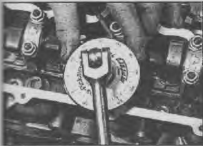
7.28б Дотяните болты головки на необходимый угол
