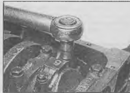
29.18б Затяните гайки крышек шатунов
