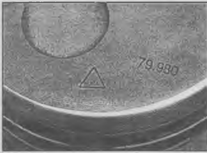
27.17 Размеры поршня проштампованы на головке поршня
