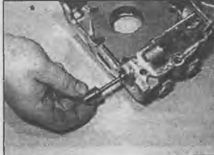
2.87. Извлечение плунжера предохранительного клапана давления
