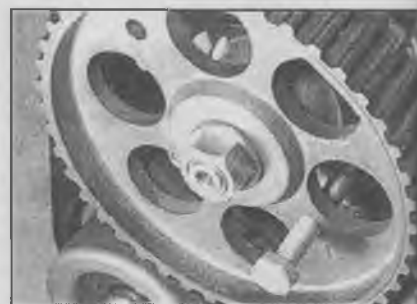
4.10б Вставьте блокировочный болт в отверстие звездочки топливного насоса
