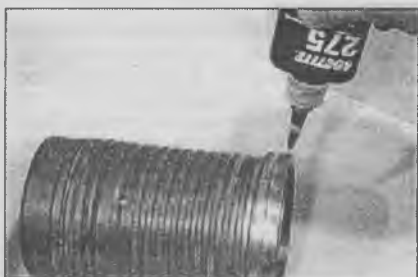
19.12б ...и на выступающую кромку гильзы – двигатель объемом 2,5 литра
