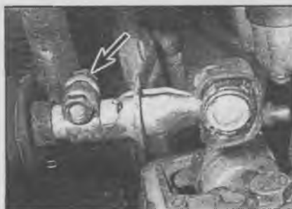
21.16 Ослабьте болт соединения рычажного механизма (указан стрелкой)
