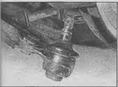
17.21 Нижнее шаровое шарнирное соединение передней подвески
