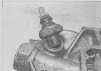
7.1 Выключатель сигнальной лампочки низкого давления масла установлен на обратной стороне масляного насоса
