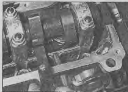
31.7 Проверка зазоров в клапанах на дизеле 17 DT
