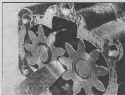
14.6а Проверьте набором щупов зазоры между зубьями шестерен ...
