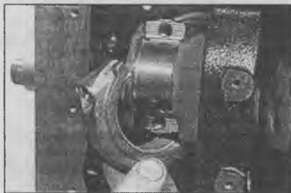
11.3б Снимите крышку вместе с вкладышем с шатуна
