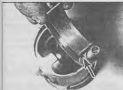
2.47. Установка шатунных вкладышей в шатун
