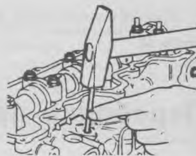
27.116 Выбейте вихрекамеры через отверстия свечей предпускового подогрева
