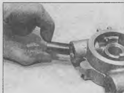
12.3б ...достаньте плунжер клапана
