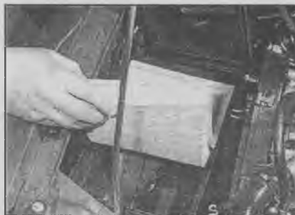
26.3 Снятие фильтрующего элемента (дизель 17D)
