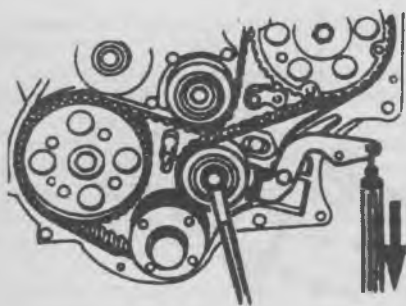
8.14 Приложите нагрузку в 9 кг к рычагу шкива натяжителя и надежно закрутите крепежный болт шкива
