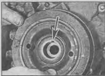
2.19. Установка шкива коленчатого вала
