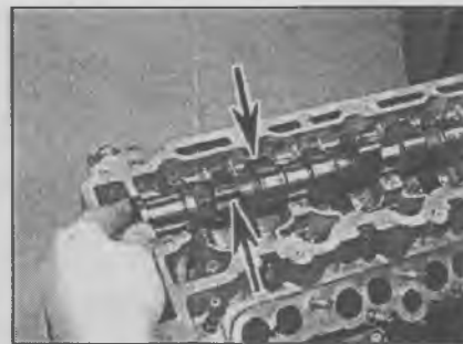
2.56. Кулачки первого цилиндра распределительного вала должны быть направлены вверх
