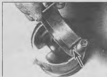
16.12 Установите вкладыши в шатуны, совместив выступ вкладыша и паз шатуна (указан стрелкой)
