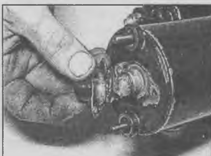
4.8 Смажьте и установите на место колпачок и шайбу
