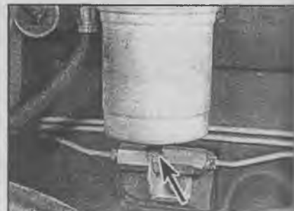
9.3 Сливная пробка топливного фильтра (дизель 16D)
