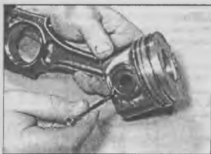
2.26. Снятие стопорного кольца с помощью тонкой отвертки
