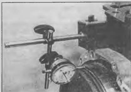
12.9 Проверка осевого люфта коленчатого вала – двигатель объемом 2,5 литра
