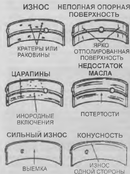
16.2 Примеры износа вкладышей подшипников коленчатого вала
