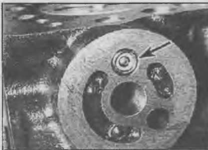
12.7 Проверьте перепускной клапан (указан стрелкой) масляного фильтра
