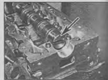
2.57. Паз на левом конце распределительного вала должен быть параллелен головке блока цилиндров
