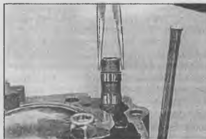
9.4 При помощи плоскогубцев достаньте регуляторы – двигатель объемом 2,5 литра
