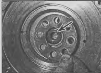
17.4 Выкрутите болты маховика и снимите круглую шайбу. Запомните установочное положение пластиковой втулки (указана стрелкой)
