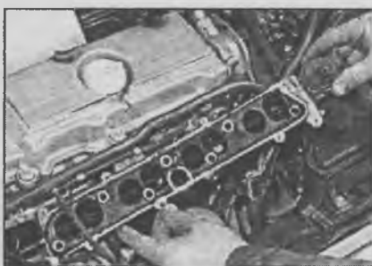
4.34. Снятие нижней секции впускного коллектора
