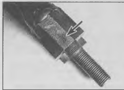
16.3 Осмотрите шатуны и крышки шатунов на наличие на них маркировки
