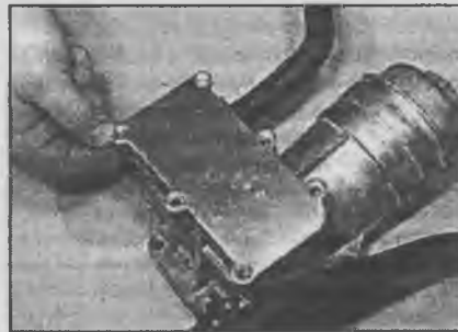
2.91. Снятие крышки масляного радиатора
