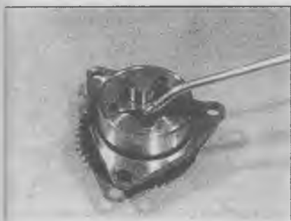
9.6 Заполните масляный насос моторным маслом.
