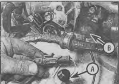
12.1а Отсоедините разъем подключения выключателя фонарей заднего хода (А) и выключателя сигнальной лампочки низкого давления масла (Б)
