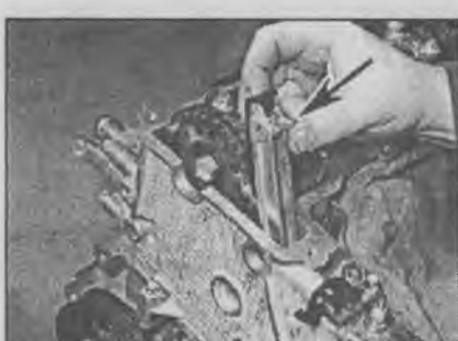
2.48. Установка верхней направляющей цепи
