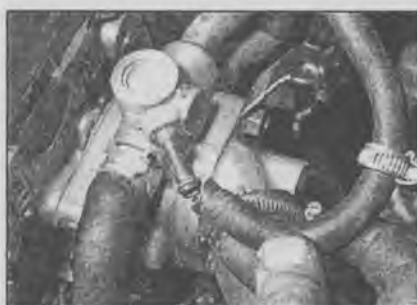
21.10 Отсоедините вентиляционный шланг от кожуха термостата
