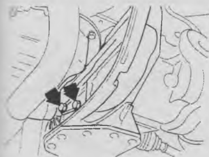
9.4 Выкрутите два болта (указаны стрелками) нижней крышки кожуха коробки передач
