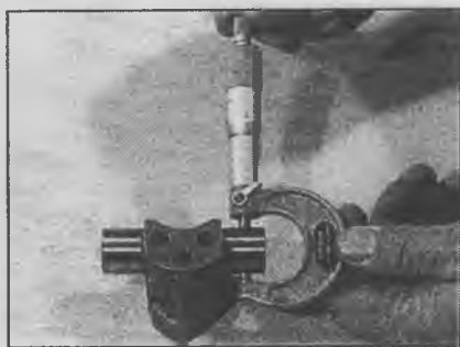
6.8 Измерьте оси коромысел при помощи микрометра
