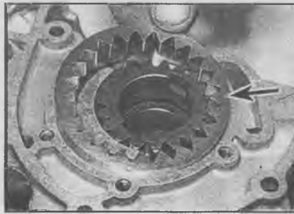
22.4 Метка (указана стрелкой) на поверхности внешней шестерни должна быть обращена наружу
