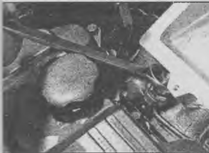
7.7a Отсоедините трубку первого инжектора, чтобы облегчить доступ к болту коллектора
