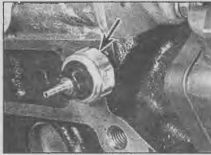
7.1 Выключатель сигнальной лампочки низкого давления масла установлен возле масляного радиатора (указан стрелкой)
