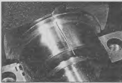
18.6 Пленка "Пластигодж", установленная на шейку коренного подшипника
