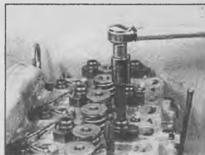
7.37б Затяните болты головок цилиндров до необходимых моментов затяжки, используя гаечный ключ с ограничением по крутящему моменту...
