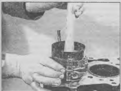
19.16 Установите поршень и шатун на место – двигатель объемом 2,5 литра
