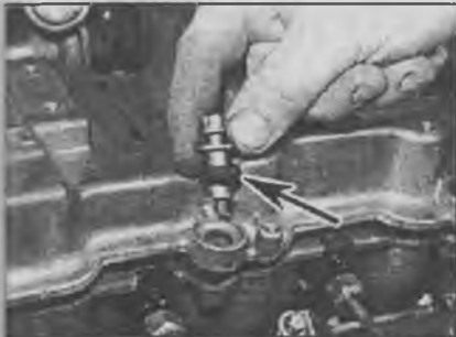
2.15. Отвинчивание болтов крепления крышки головки блока цилиндров
