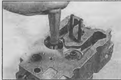
8.3б ...и установите их до конца на место при помощи накидной головки или специального инструмента
