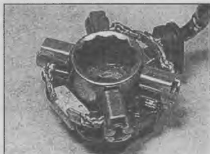
4.7 Вставьте отрезок трубки большего диаметра между щетками, вдавив щетки вглубь держателей
