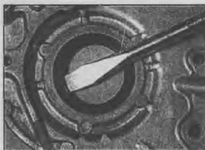
18.8 Извлеките передний сальник коленчатого вала
