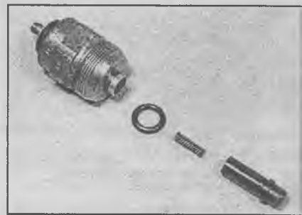
13.2 Клапан отсечки топлива, уплотнительное кольцо, пружина и плунжер
