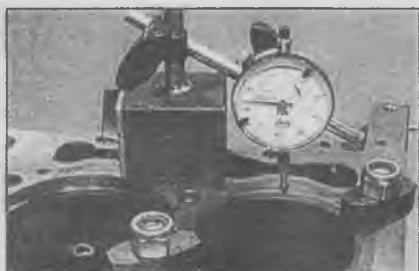
13.186 Проверка выступа гильзы над поверхностью блока цилиндров – двигатель объемом 2,5 литра
