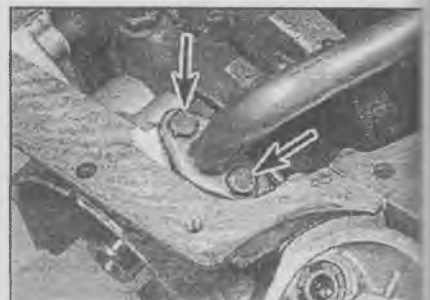
29.23б Затяните крепежные болты фланца маслозаборного патрубка (указаны стрелками)
