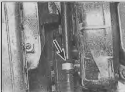
34.10а Удалите хомут шланга вакуумного усилителя тормозов (стрелка)...
