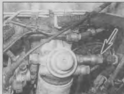
4.10. Температурный переключатель элемента подогрева топливного фильтра (указан стрелкой) – двигатель объёмом 2,3 литра
