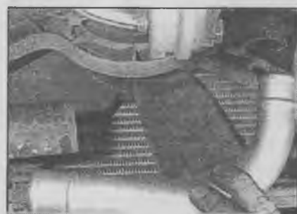
17.3а Снимите трубку воздушного радиатора
