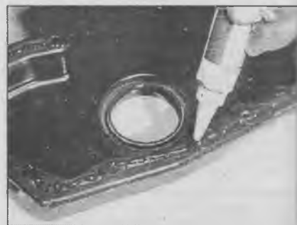
8.12 Нанесите на стыкующуюся поверхность крышки зубчатых передач слой герметика
