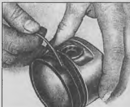
27.14 Почистите канавки поршневых колец
