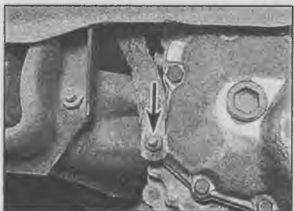
17.23 Крепление провода заземления коробки передач (указано стрелкой)
