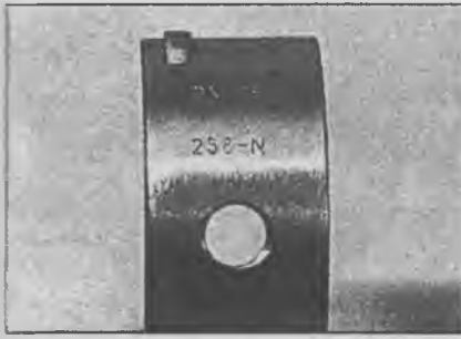
2.34. Расположение метки идентификации на основании подшипника
