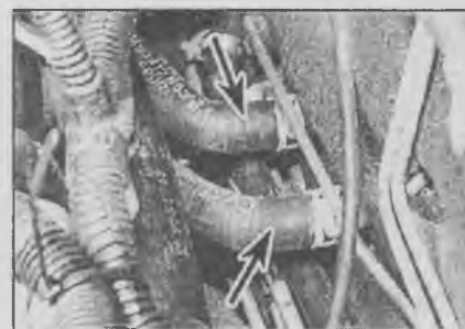
21.8 Отсоедините два шланга (указаны стрелками) от трубок обогревателя
