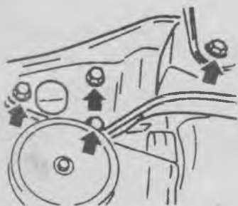
19.1б Снимите кронштейн левой опоры вместе с опорой (болты указаны стрелками)
