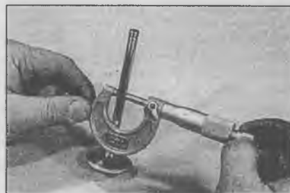
7.10 Проверка диаметра штока клапана
