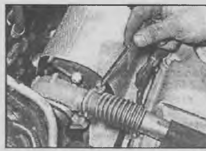
4.3. Отвинчивание зажима, крепящего металлическую трубу к турбонагнетателю
