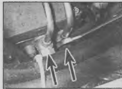
4.15. Отвинчивание болтов крепления подающей и возвратной топливной трубы с топливного насоса
