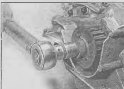
29.35б Затяните болт звездочки коленчатого вала
