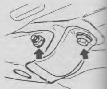
19.1г Выкрутите болты (указаны стрелками) задней опоры двигателя
