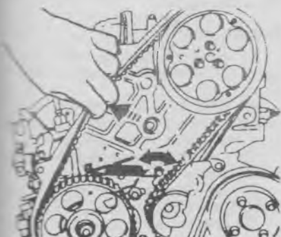
4.18 Установите пружину натяжителя и проверьте, как функционирует натяжитель.
