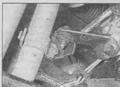
17.16б Кронштейн выпускной трубы
