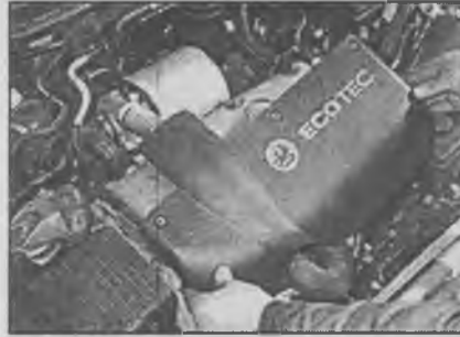
2.13. Снятие защитного пластикового кожуха с верхней части крышки головки
