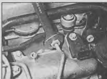
4.28. Отвинчивание соединительной гайки крепления трубы подачи топлива к форсунке
